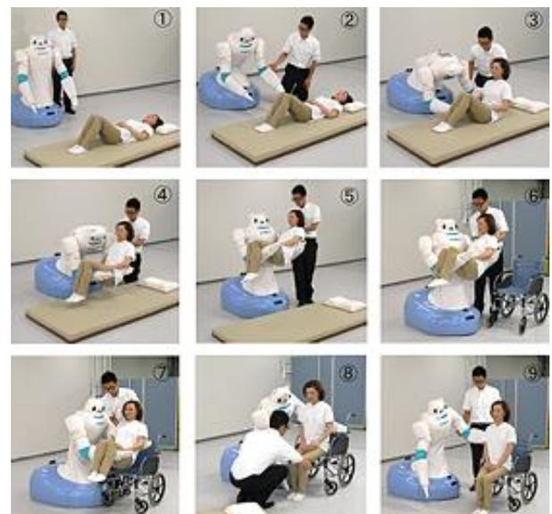
図2 触覚ガイダンスによる移乗作業
